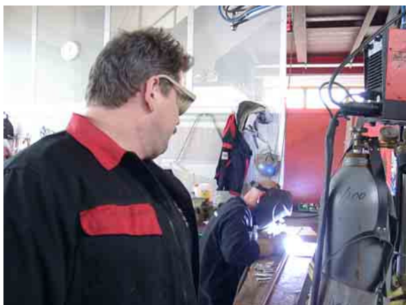
Edelstahl wird per Lichtbogen-Schweißen bearbeitet. Augenschutz ist dabei Pflicht.
