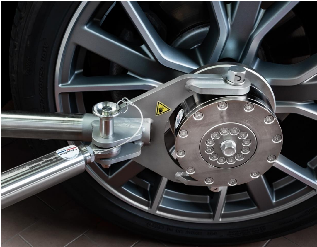
Abbildung 31: Korrekt montierter Kugelsperbolzen
