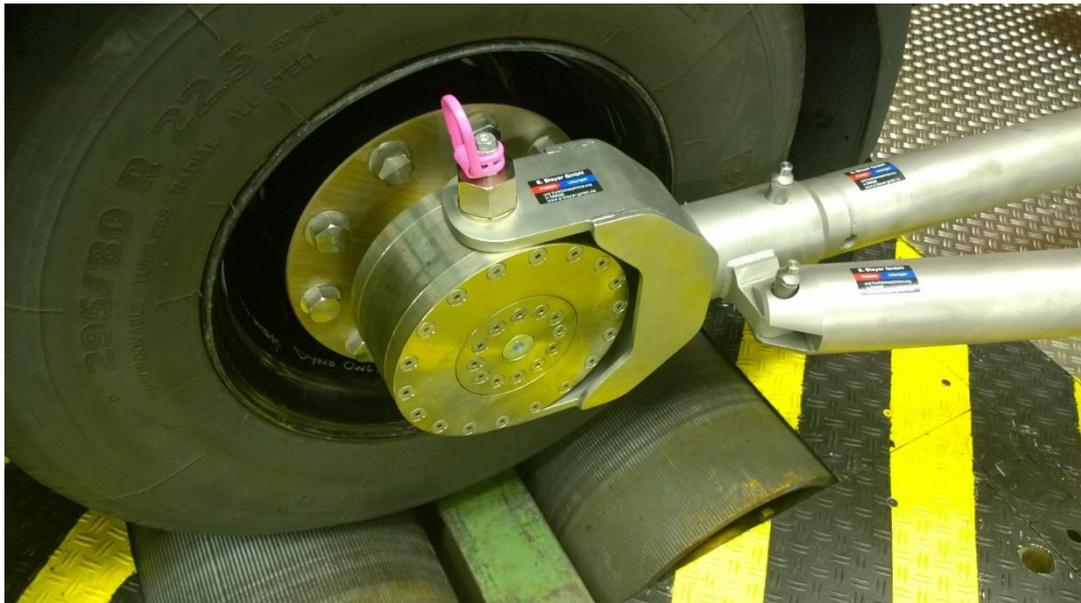
Abbildung 22: Korrekt montierte Fixierung am Rad
