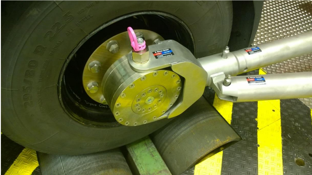
Abbildung 22: Korrekt montierte Fixierung am Rad
